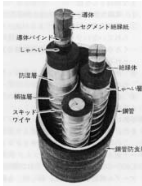
図2 - 7 POFケーブルの構造
